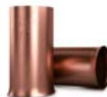
AT-072NCXX: Adaptadores de cobre de diámetro variable donde XX indica los mm 2 del cable final. Se utilizan para incrementar la sección de un conductor de forma que acopla en un molde diseñado para ese cable XX de mayor tamaño. XX = 50, 70, 120...
